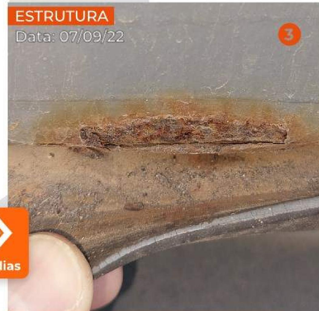
Na foto 1, observa-se pontos com corrosão, na estrutura da base inferior da porta, localizada junto à borracha de vedação, causando corrosão pelo acúmulo de água e umidade, no momento da instalação da tecnologia Rustless.
