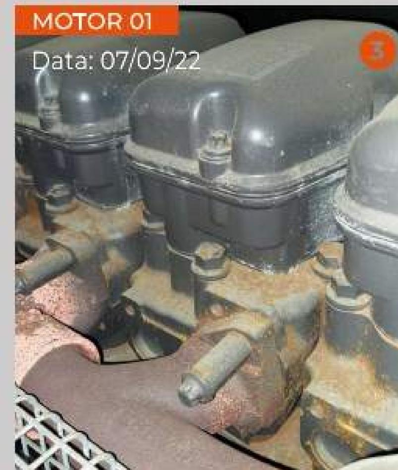
Motor 01 Scania, mostra pontos de corrosão ativos nas superfícies superiores e inferiores do bloco do motor, na data de instalação da tecnologia Rustless.
